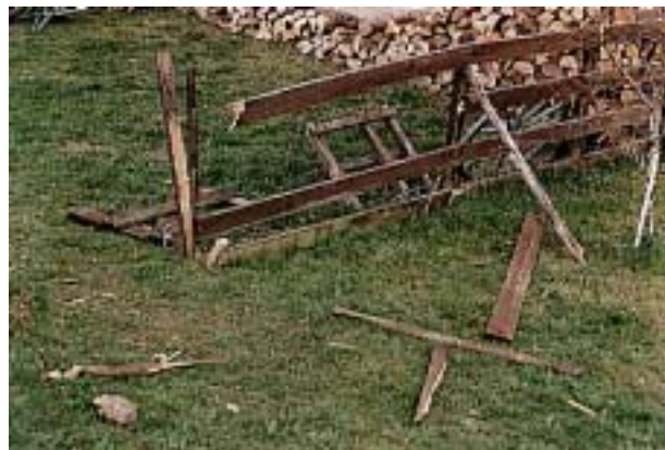
Photo 4 : barrière de bois détruite par le courant de foudre (photos Alex Hermant).
